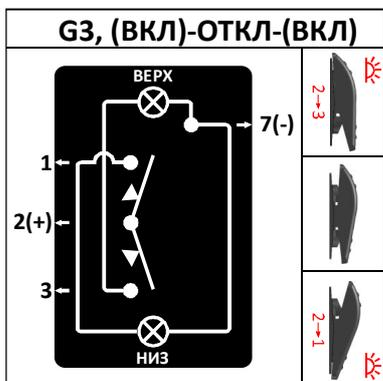
**Верхнее положение:** включен, НЕ фиксированное, горит верхний светодиод, замкнуты контакты: **2 → 3**
